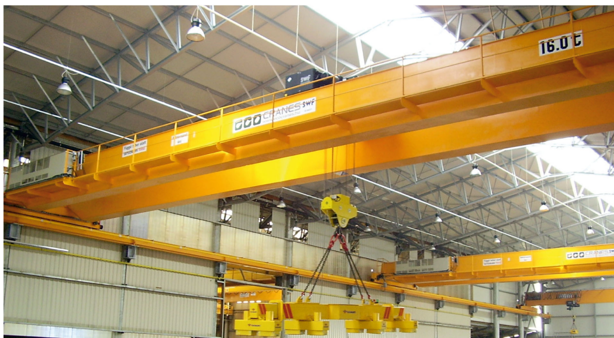
16t-ás kétfőtartós daru elektromágneses megfogóval
