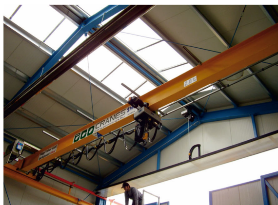
2t-ás egyfőtartós daru villamos láncos emelőművel
